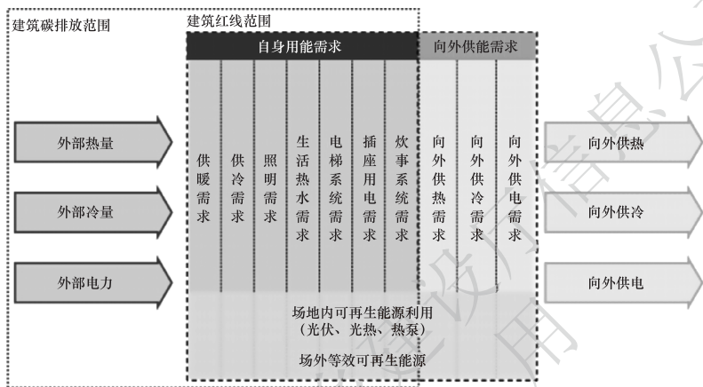
图1 建筑用能系统及建筑碳排放范围
